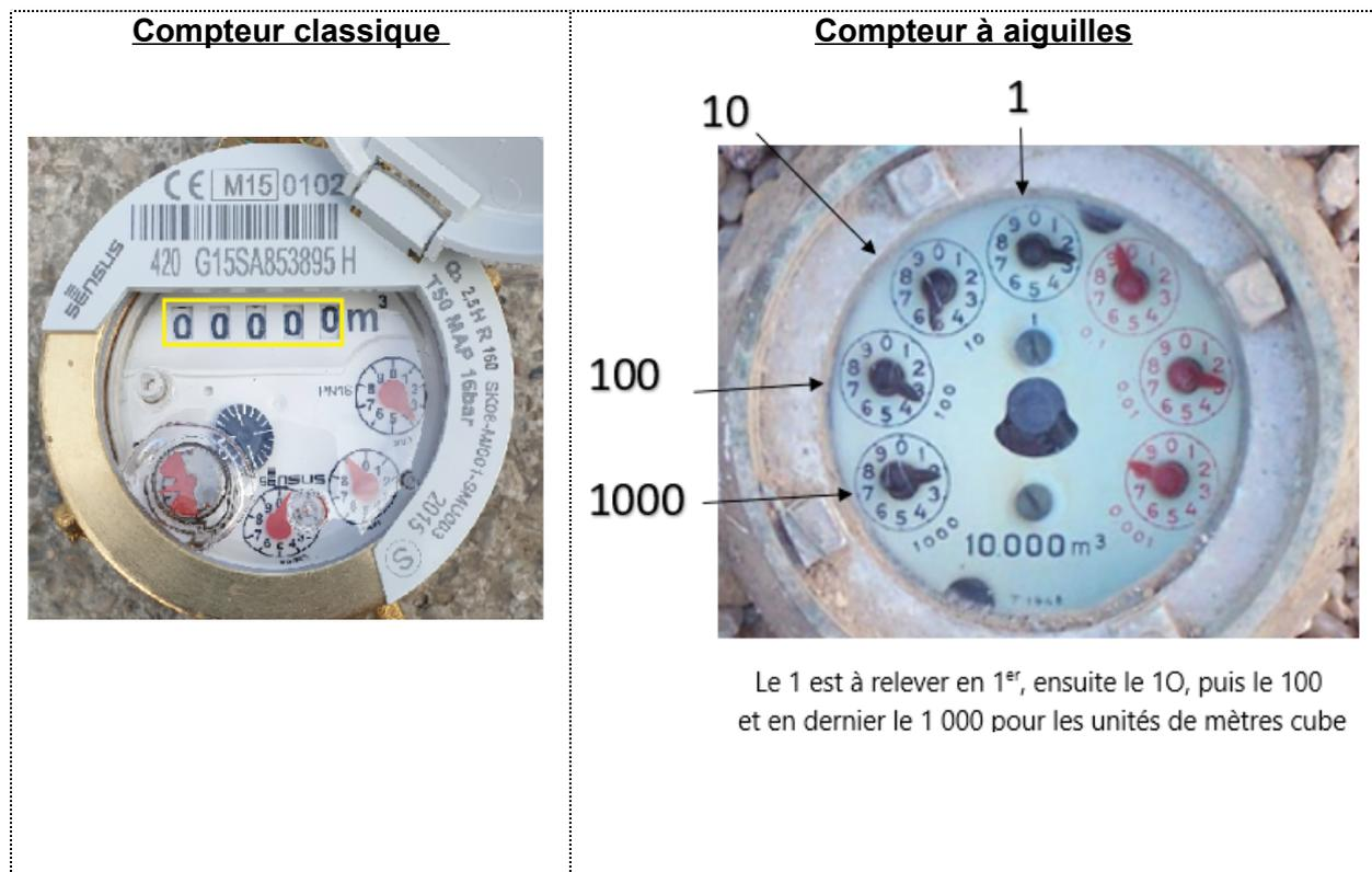
Pour établir sa facturation, **la mairie de Mollans-sur-Ouvèze n'utilise que les chiffres correspondant au mètres cube** (1 m<sup>3</sup> = 1 000 litres) en blanc sur fond noir ou en noir sur fond blanc. Il est donc inutile de nous communiquer les chiffres correspondant aux litres, décalitres et hectolitres en blanc sur fond rouge ou en rouge sur fond blanc.
